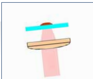
1. La luz IR atraviesa la muestra
